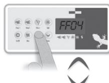
Appuyez sur les touches **Up** ou **Down** pour définir la fréquence du cycle (de 1 à 4, selon la durée du cycle). Lorsque la valeur désirée apparaît, appuyez sur la touche **Filter** pour confirmer. Le marqueur « Filtration » est allumé lors d'un cycle de filtration.
