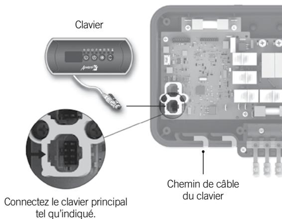
Pour connecter le clavier, insérez le connecteur in.link dans le connecteur de clavier approprié (tel qu'illustré).
