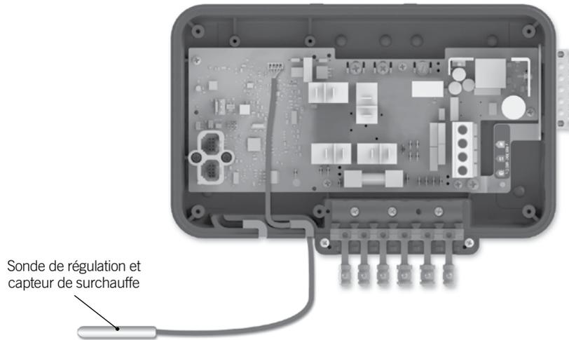
La sonde doit être installée dans le spa, sous l'eau, dans une zone où l'eau est en mouvement, afin d'optimiser la régulation de la température.
