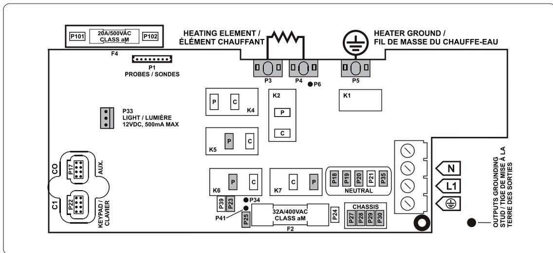
Assurez-vous que tous les accessoires sont connectés à la cosse de mise à la terre sur le côté du système de contrôle.
