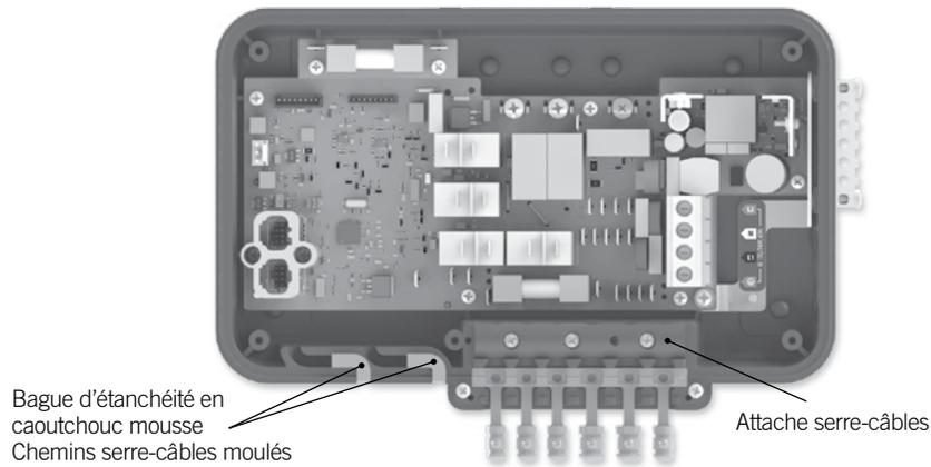
Lorsque tous les câbles basse tension sont insérés par les chemins serre-câbles moulés au fond du boîtier du système de contrôle, comblez les interstices à l'aide des bagues d'étanchéité en caoutchouc mousse qui vous sont fournies.
