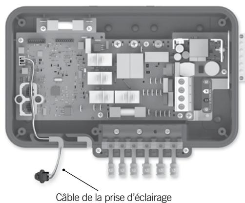
Pour connecter le câble de la prise d'éclairage, insérez le connecteur MTA dans le connecteur P33 de la sortie d'éclairage à 12 V CC (tel qu'illustré).
