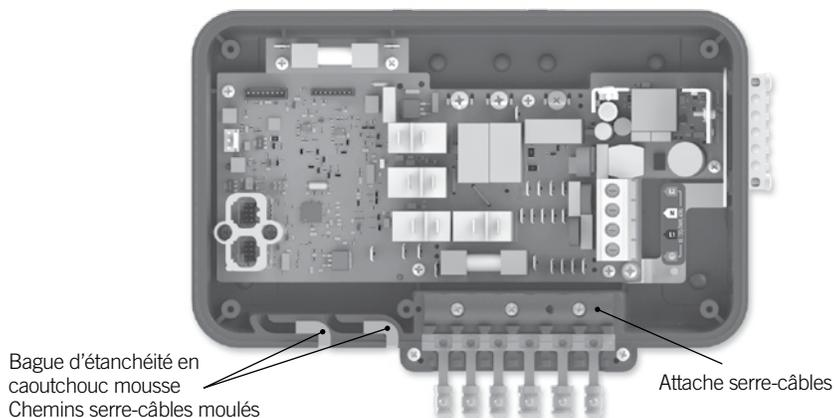
À l'aide d'un tournevis Phillips, enlevez les vis qui retiennent le couvercle, à l'avant du système de contrôle.
