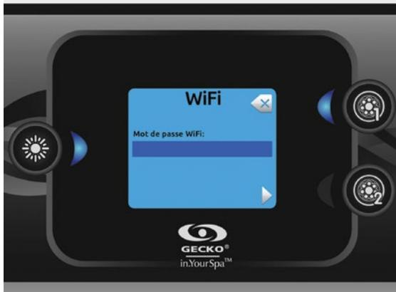
Une fois dans le menu WiFi après quelques secondes les différents réseaux visibles par le module in.touch s'afficheront dans la fenêtre avec la force de chaque signal. Utiliser les touches Haut/Bas pour vous déplacer dans la liste. Pour sélectionner un réseau WiFi, appuyez sur la touche Lumière.
