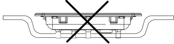
Le dos du in.k500 ne doit pas être logé dans un espace où l'eau peut s'accumuler, mais être laissé découvert.
