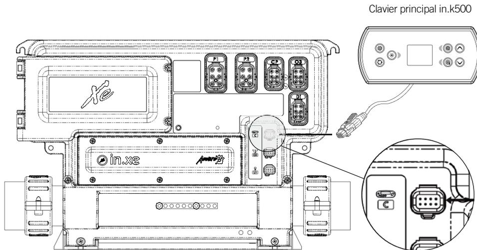
Pour brancher le clavier in.k500, insérez simplement le connecteur in.link dans le connecteur de clavier correspondant qui est situé sur le boîtier du système de spa (comme illustré sur la figure).
