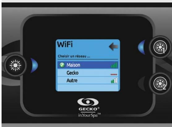
Lorsque le module in.touch est connecté à un réseau WiFi, un crochet dans un cercle vert s'affiche vis-à-vis celui-ci dans le menu WiFi et le logo change au vert dans la page *Réglages*.
